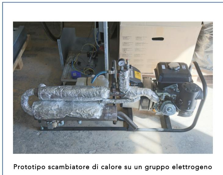
Prototipo scambiatore di calore su un gruppo elettrogeno
